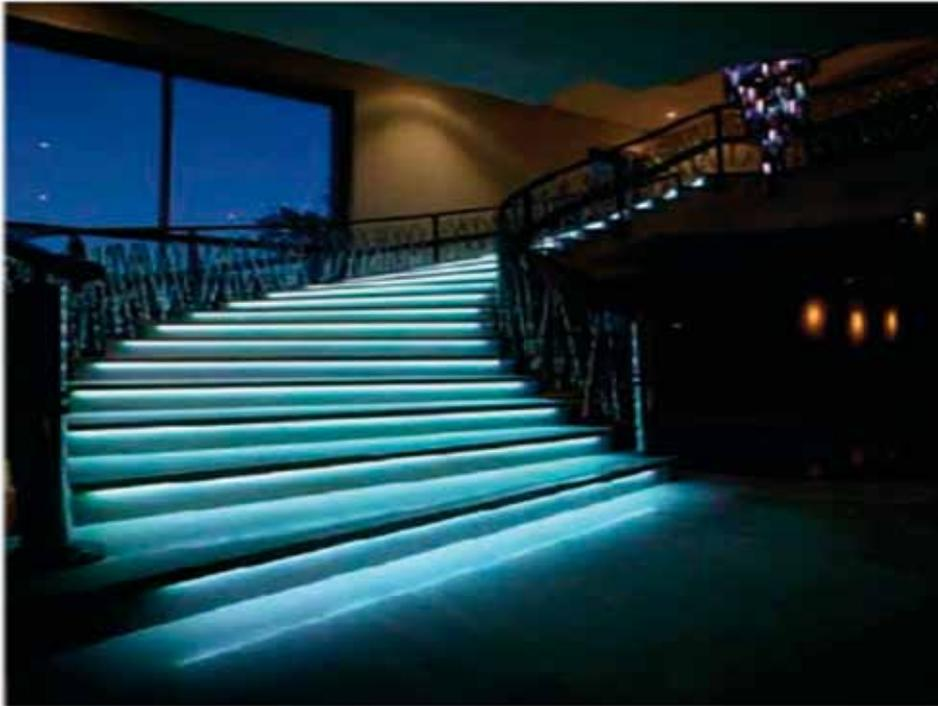
Pour un éclairage puissant dans des conditions d'utilisation difficiles (humidité, marches d'escalier etc...), optez pour les barres de LED enchâssées dans des barres d'aluminium en U et rendues étanches grâce à de la résine.
